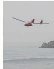
津波被害調査で使用した小型無人機（飛行ロボット）
