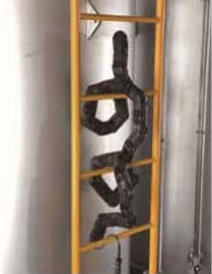
はしごに登る「ヘビ型ロボット」(世界初)移動して、はしごに取り付き登って、タンクの上の口から内部をチェックする作業ができる。ケーブルがはしごに絡まないのがすごい。
